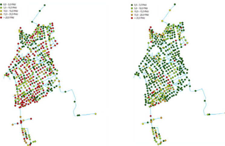
Bild 8: Trübung vor (links) und nach dem Spülen (rechts)
