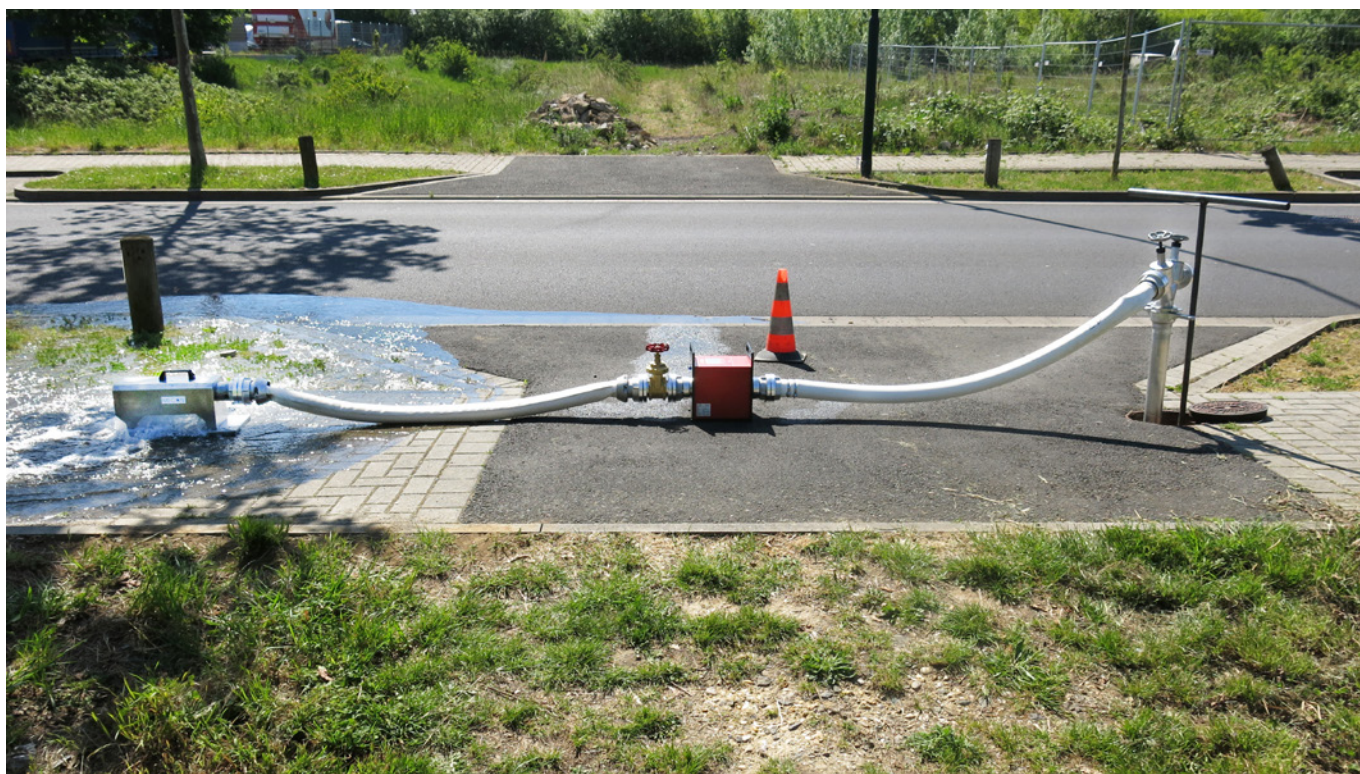
Bild 1: Messstrecke mit mag-flux HTL und Druckvernichter
