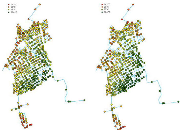
Bild 7: Temperaturverteilung vor (links) und nach dem Spülen (rechts)
