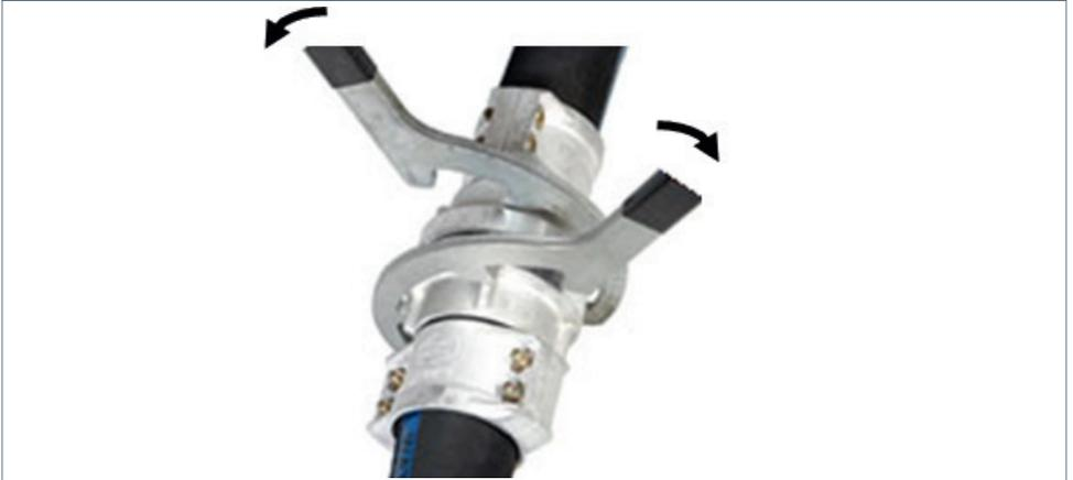
Abbildung 2: Storz-Verbindung mit Hakenschlüssel
