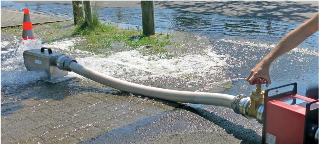
Der mag-flux® HTL ist ein mobiles Hydrantenprüfgerät, entwickelt für die Anforderungen der modernen Wasserwirtschaft und des Brandschutzes. Mit diesem innovativen Gerät können Sie schnell und präzise die Leistungsfähigkeit von Hydranten überprüfen und umfassende Wassernetzanalysen durchführen.
