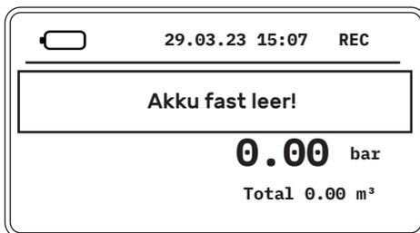
Bei einem geringen Akkuzustand wird, zum Schutz und zur Vermeidung einer Tiefentladung, ein zusätzlicher visueller Hinweis im Display angezeigt (s. Bild). Das Gerät kann nun durch kurzes Drücken der „OFF / Enter“ Taste ausgeschaltet werden.
